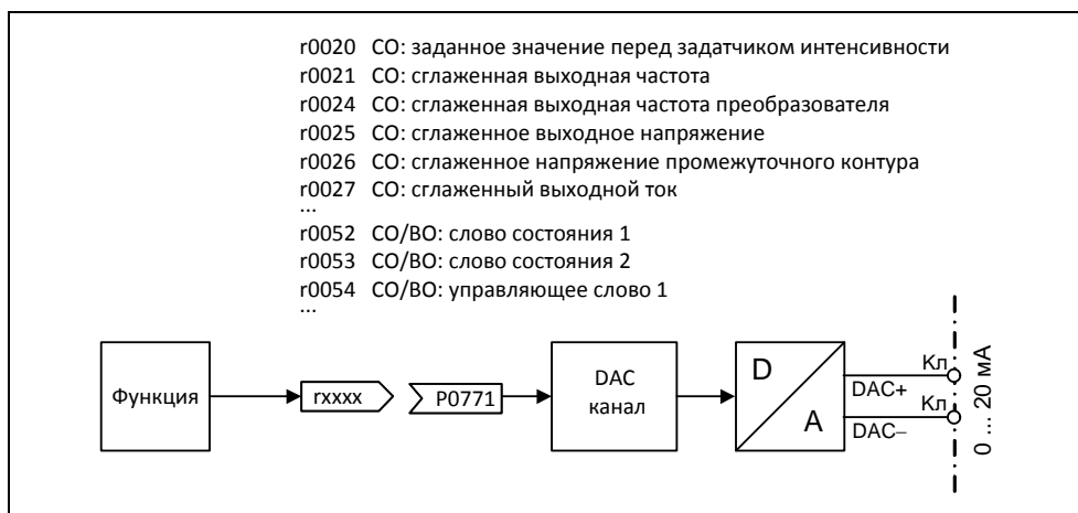
Рис. 3-34 Вывод сигнала через DAC-канал
